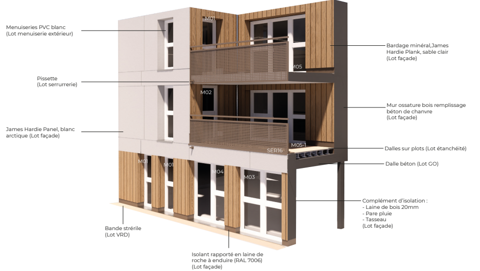
Détail prototype de façade. ■ 2024 ■ ©Cinq-Cinq
