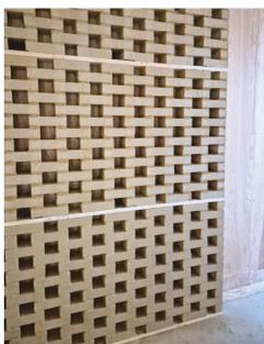
Prototype du mur intérieur de briques de terre crue pour le rafraîchissement • 2024 • ©ABF-LAB
