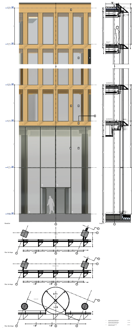
Détails techniques des modules de façade et de la porte tambour d'entrée ©GAF / ArtBuild
