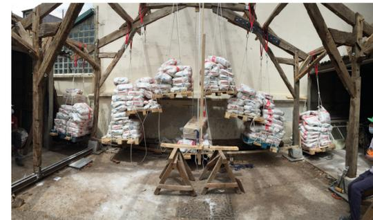
Vérification de la charpente par un test de mise en charge aux ELS avec des sacs de chaux • ©A+1
