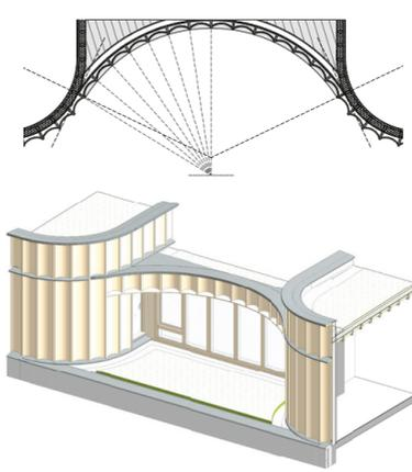
Axonométrie et principe bardage cintré
