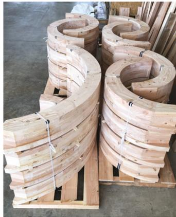
Lineaux cintrés fabriqués par le charpentier 2023 • ©Charpentiers du Haut Beaujolais
