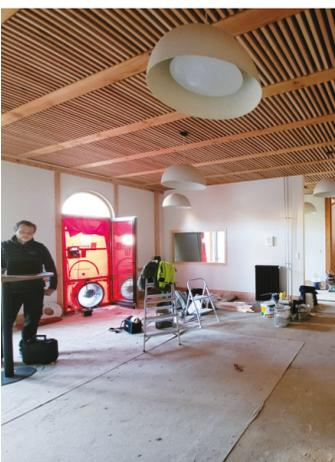
Test d'étanchéité à l'air réalisé par Aerology, en présence de Vincent Pierre de Ferranergie • 2024 • ©Julie Herrgott
