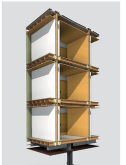
Détail constructif. Superposition de 3 modules sur la charpente métallique • ©Dhominio
